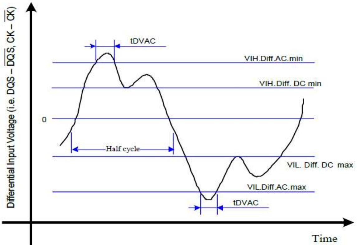
**DDR3 Allowed time before ringback (tDVAC) for CK -  $\overline{\text{CK}}$  and DQS -  $\overline{\text{DQS}}$**
